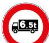
F.R 261 060 B transito vietato ai veicoli superiori a ... t a pieno carico
